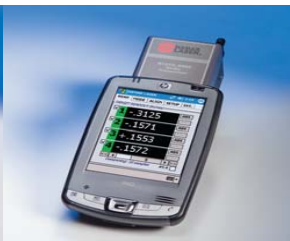
Letture R-1310 PDA Wireless (900MHz o 2.4GHz), mostra fino a 4 sensori simultaneamente
